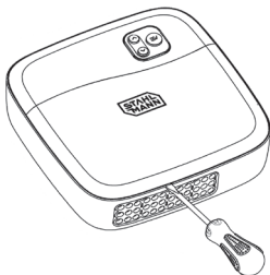
Рис. 2 Снятие крышки модуля управления
